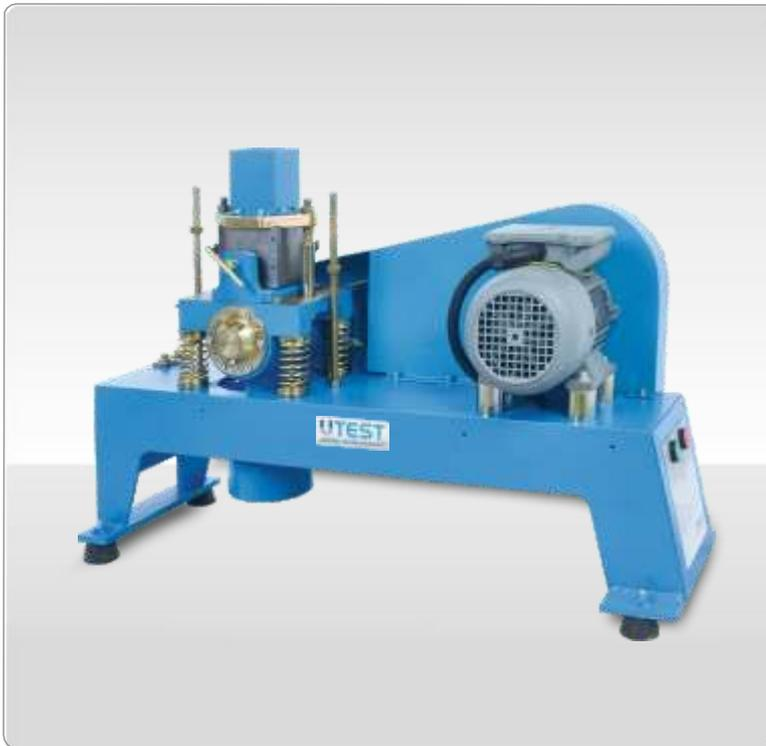
La machine à vibrer UTCM-0930 est utilisée pour la préparation et le serrage des éprouvettes cubique de mortier de 70,7 mm.
