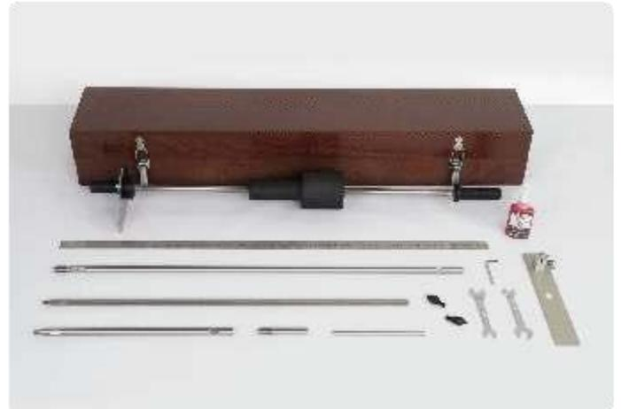
Le pénétromètre dynamique à cône TRL est fourni avec :
