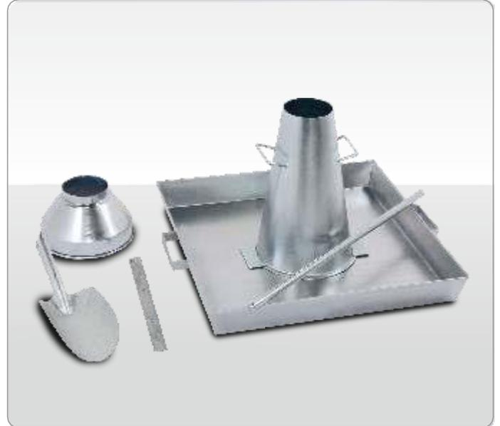
Le kit de cône d'Abrams est fourni complet avec :
