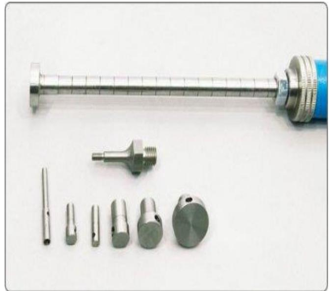
Les pénétrromètres à mortier UTC-0700 et UTC-0701 sont utilisés pour déterminer le temps de prise du mortier dans le béton frais. L'appareil consiste en un dispositif de charge à ressort gradué.
