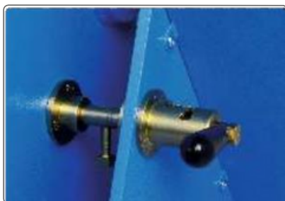
Verrouillage de la position du tambour avec interrupteur de sécurité
