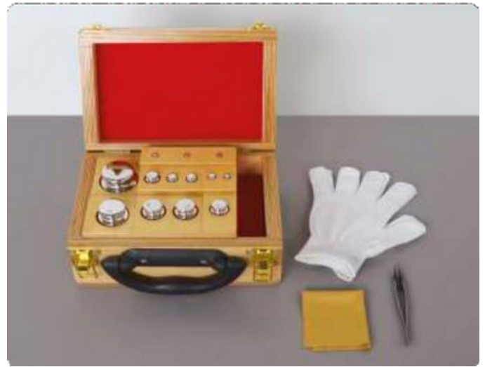
Jeu de poids d'étalonnage (UTW-0900 classe M1 et UTW-0920 classe F1)
