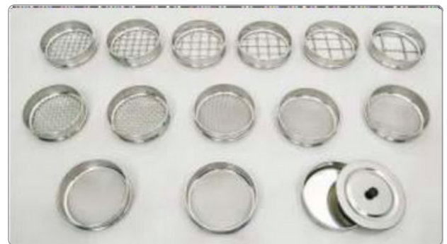
Tamis à tamisage humide avec fonds de collecte et couvercle
